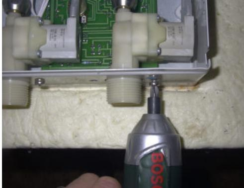
Ventil-Befestigungsschrauben am Gehäuse lösen
