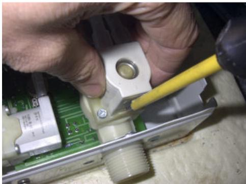
Mit einem spitzen Schraubenzieher Halte-lasche der Ventilschule vorsichtig etwas abreißen und Spule abziehen (u.U. etwas schwergängig)
